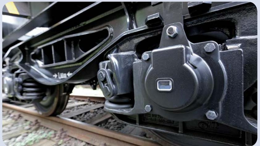
Die Firma Kaminski Waggonbau GmbH hat einen elektronischen Laufleistungszähler entwickelt, welcher anstelle eines Standarddachsdeckels an das Lagergehäuse eines Güter- oder Kesselwagens montiert werden kann.
